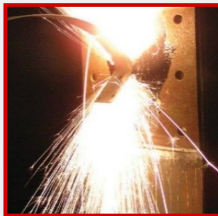
Lichtbogen-Shunt während des API-Tests.
